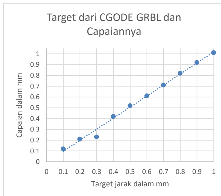
Gambar 13. Target jarak yang diinginkan dari GRBL vs Hasil jarak aktual yang didapatkan
